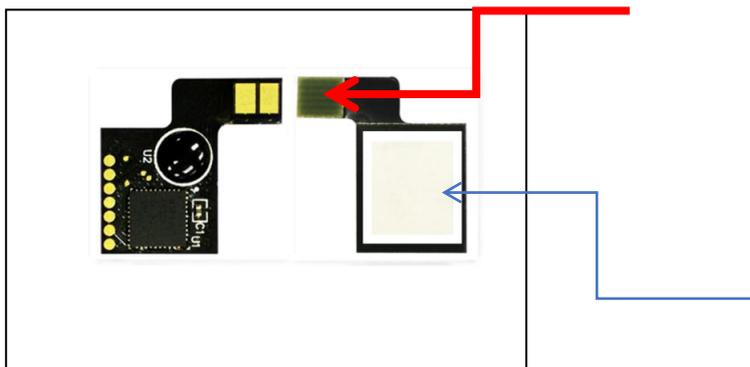
Рекомендуем удалить защитную пленку после фиксации контактной площадки на корпусе картриджа.
