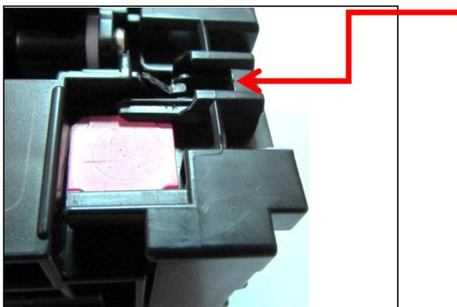
2. Зафиксируйте на корпусе картриджа контактную площадку совместимого чипа.
