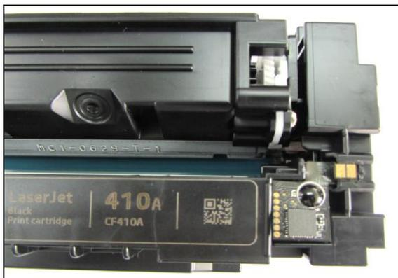
Контактные площадки совместимого чипа, должны быть спозиционированы на корпусе картриджа строго, как у OEM чипа.
